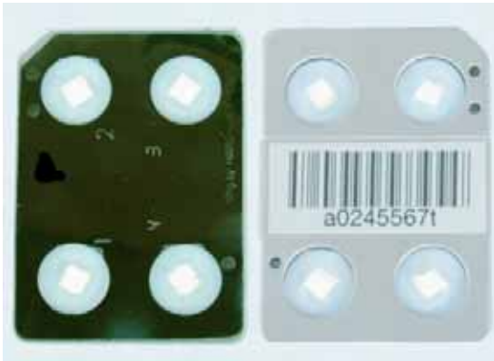
Abb. 34: Thermolumineszentes Albedo-Dosimeter. Außenmaße 31 mal 43 mm 2 , TLD 4 mal 4 mm 2 .
