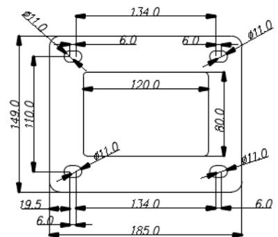
**Darstellung Abdeckung Bodenplatte/Schrauben**
