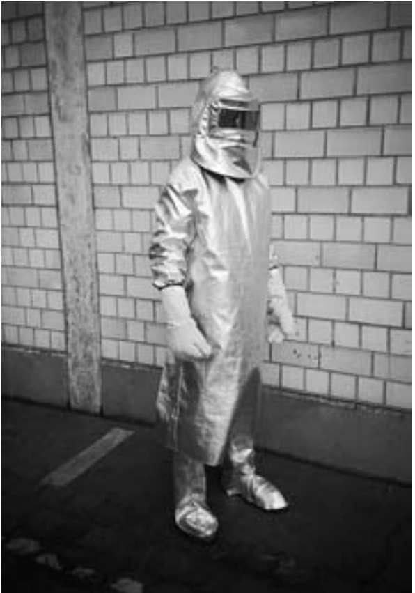
Bild I.3.4-1: Frontalschutz mit aluminierter Oberfläche sowie Kopfschutzhaube mit geschlossenem Visier
