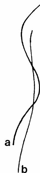
Bild 3: Schematische Darstellung des Spurverlaufs von Vorderrad (a) und Hinterrad (b) bei niedriger Geschwindigkeit.
