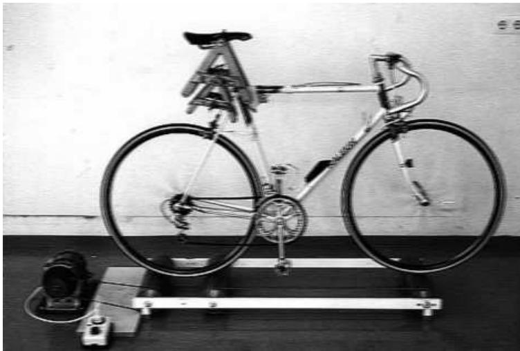
Abb. 1. Freifahrendes Fahrrad auf dem Rollentrainer (Zwei Rollen am Hinterrad, eine am Vorderrad)
