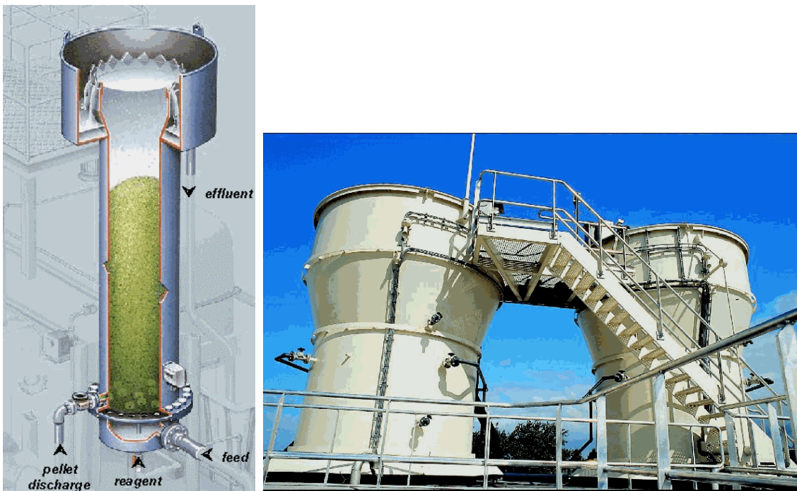
Bild 5.2: Prinzip des Crystalactor ® und Ansicht der Reaktoren in Geestmerambacht (GIESEN und DE BOER, 2003)
