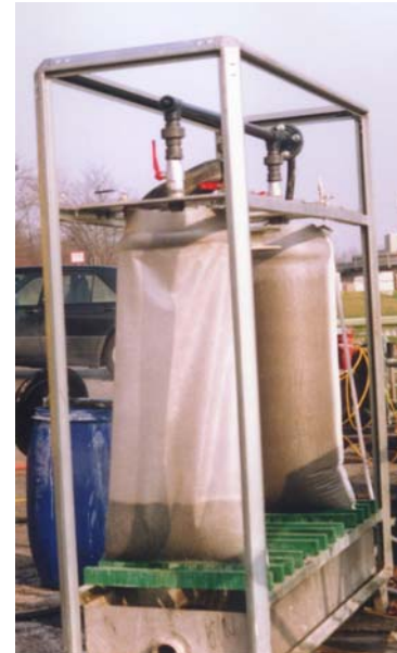
Bild 9.2: Absackvorrichtung der MAP-Pilotanlage Zentratwasserbehandlung der Firma NALVA
