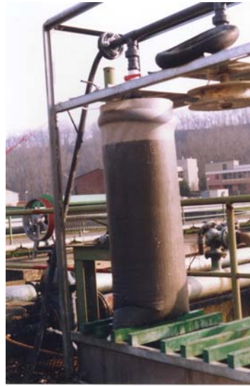
Bild 9.2: Absackvorrichtung der MAP-Pilotanlage Zentratwasserbehandlung der Firma NALVA
