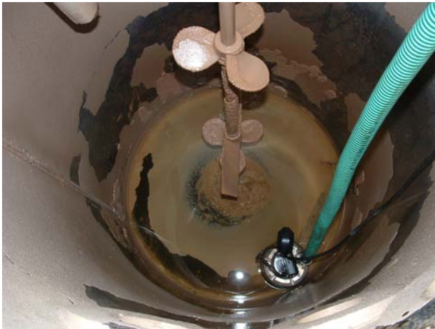
Bild 8.40: Mischreaktor mit anhaftendem braunen Kalkfällschlamm
