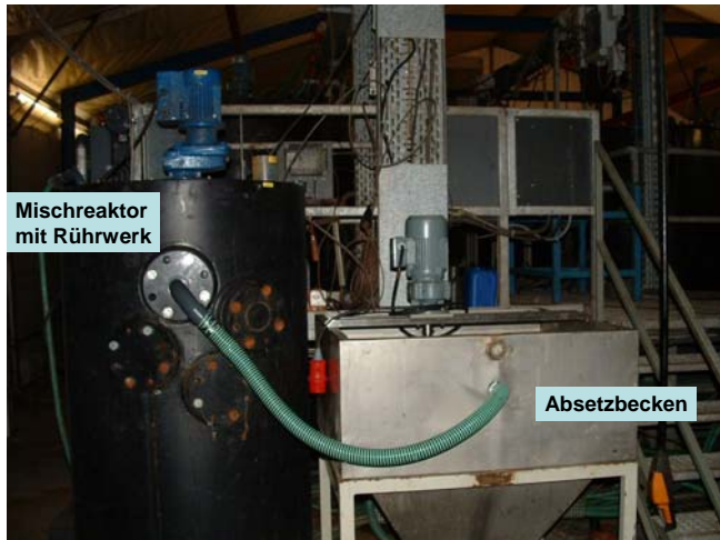
Bild 8.38: Mischreaktor mit Rührwerk und Absetzbecken der Nachfällungseinheit
