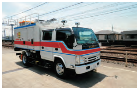
架台を格納した電気検測車
