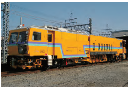
道床をつき固めるマルチプルタイタンパー
