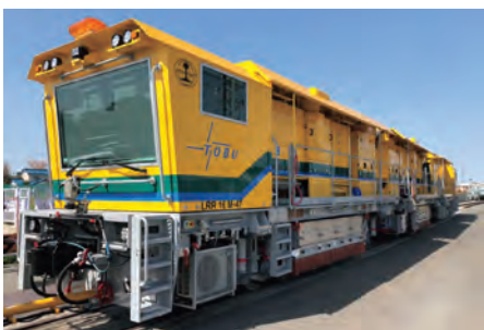
レールの表面を削るレール削正車
