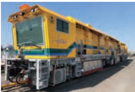
レールの表面を削るレール削正車
