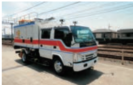
架台を格納した電気検測車
