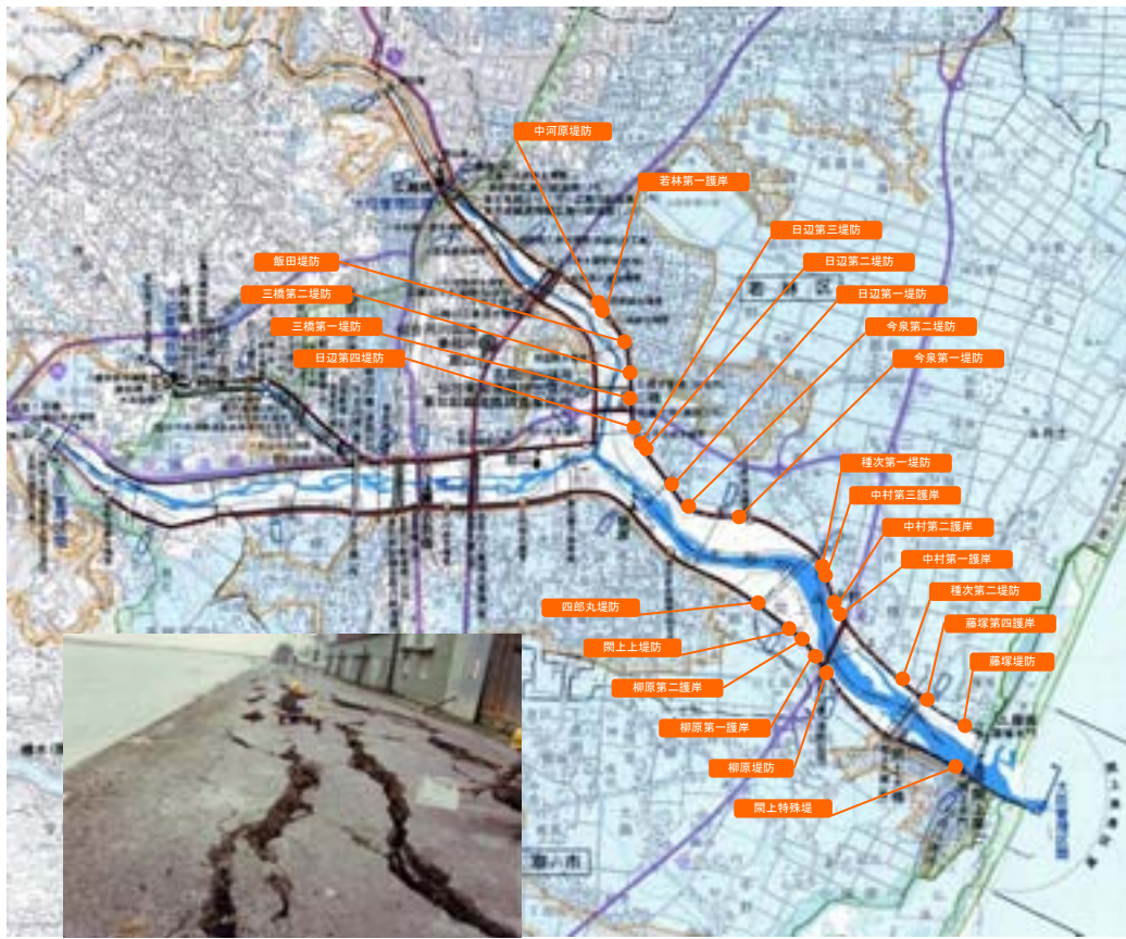
護岸背後の亀裂状況
