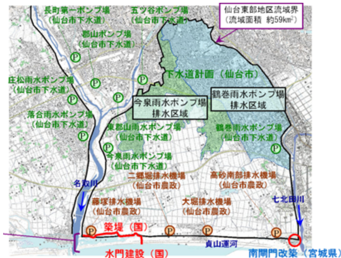
図 5.1.8 内水対策の取り組み状況
