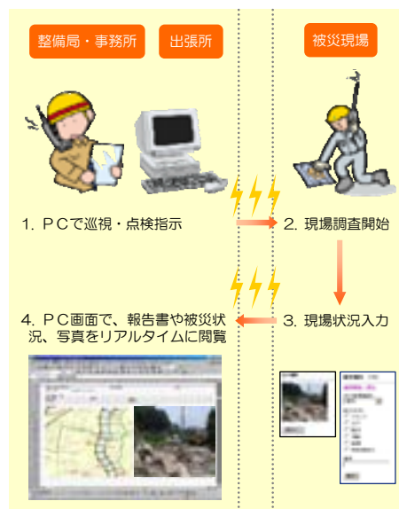
図 5.2.7 河川巡視点検システムのイメージ
