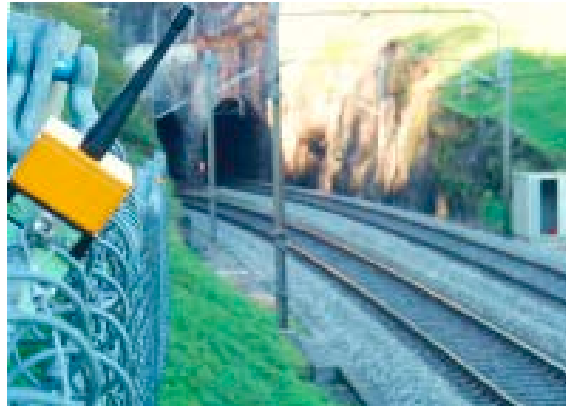
Figure 19: Filets de protection munis de capteurs. Photo: T. Meisel/IPS - INGLAS
