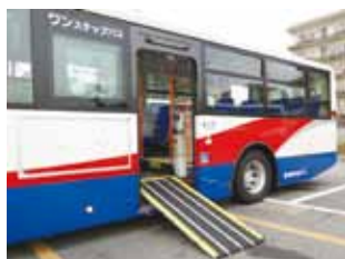
スロープ板やニーリング機能*の付いたワンステップバス *車高調整機能
