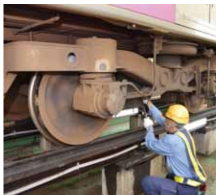
台車の点検(月検査)
