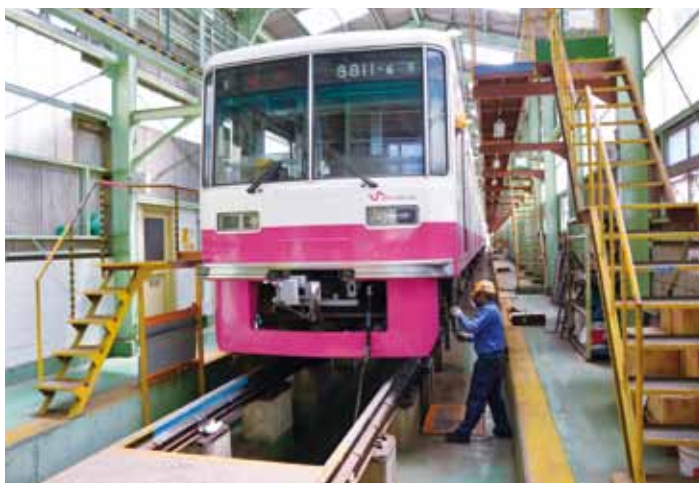
ブレーキ装置の点検（月検査）
