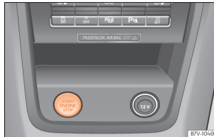
Pilt 237 Süütenupp keskkonsoolis (vaid kaugvõtmega autol)
