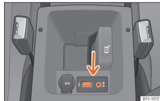
Pilt 218 Valiste signaallikate pesad AUX-IN ja USB ees keskmises käetoos
