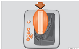
Pilt 51 Automaatkäigukasti käiguvalitsa asendid
