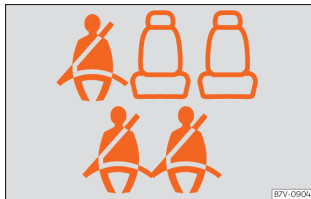
Pilt 85 Turvavööde märgukuva 7-istmelisel autol: ülaosas tagaistme, all paraistme kohta
