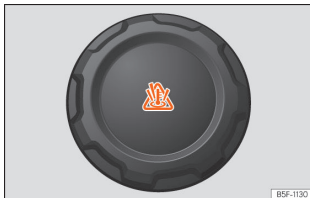
Pilt 58 Mootoriruumis: jahutusvedeliku paagi kork
