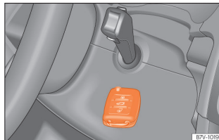
Pilt 238 Kaugvõtme kasutamine hädakäivitamisel
