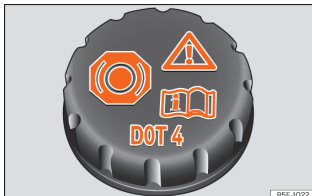
Pilt 59 Mootoriruumis: pidurivedeliku paagi kork
