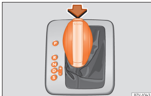
Pilt 241 Automaatkäigukasti käiguvalits ja selle lukustusnupp (nool)
