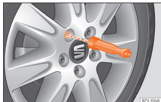
Piilt 73 Ratta vahetamine. Poldid tuleb enne auto tõstmist lõdvendada
