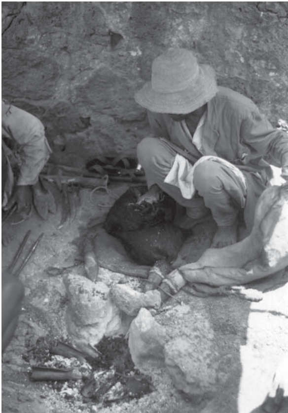
Abb. 1: Schmieid mit Schlauchblasebalg arbeitend auf einem Markt nahe Addis Abeba im Jahre 1969. Foto: W. Raunig
