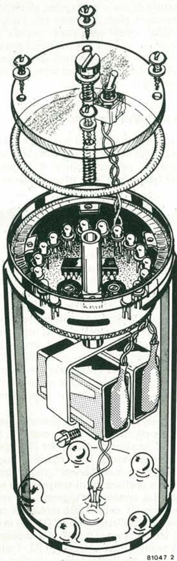
Figura 2. La vista laterale "in trasparenza" del termometro, mostra la sistemazione di base dei componenti che servono per la realizzazione.
