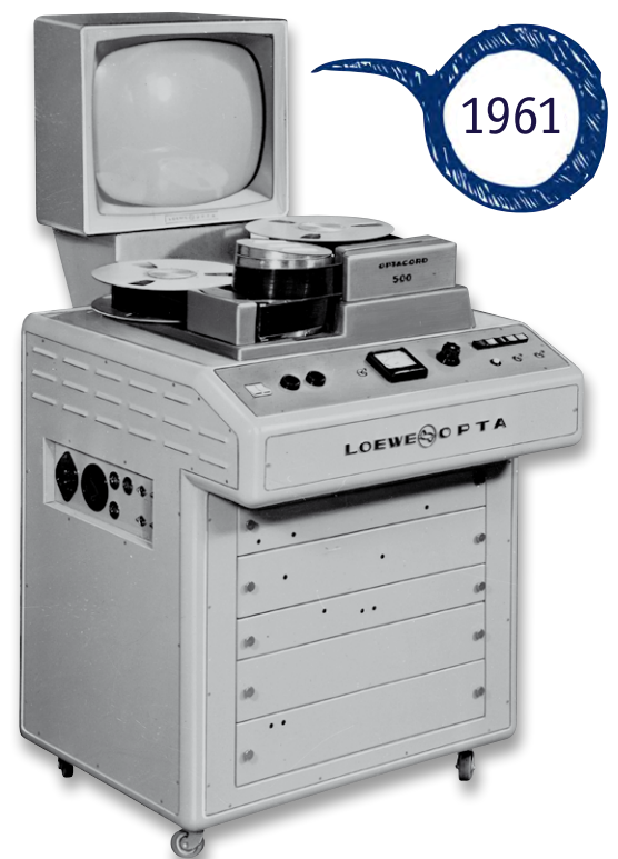
Bild 13: Wieder bahnbrechende Technik – der erste Heimvideorecorder mit Schrägspuraufzeichnung, der „Optacord 500“ von 1961
