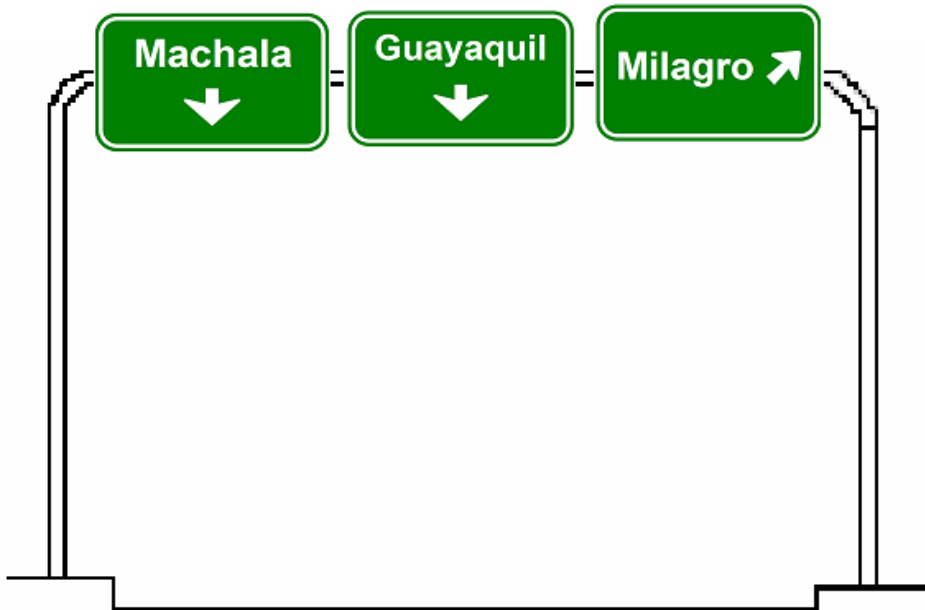
FIGURA 8.8 Ensamblaje típico de señales aéreas con asignación de carril (con carril de salida)
