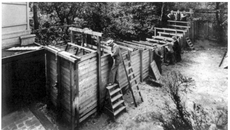
Een zeer vroege voorloper van het klapclub-onderzoek. Rijkswaterstaat bouwde in 1920 in de tuin van een van haar Haagse gebouwen een modelgoot om de golfploep te meten.
