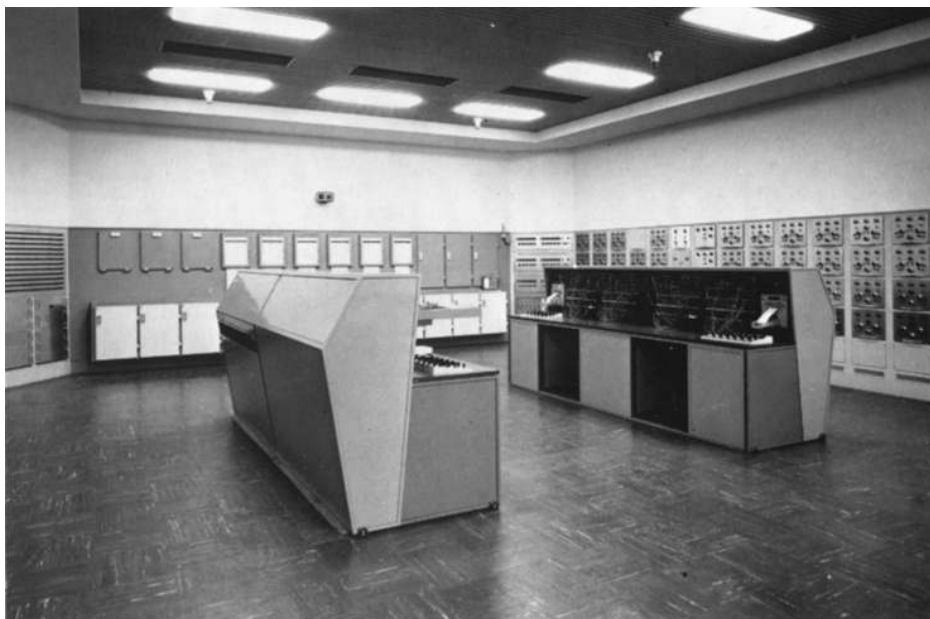
De DELTAR, de analoge rekenautomaat voor de Deltawerken.
