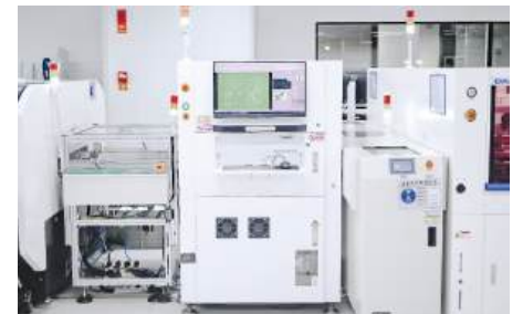
全自动锡膏检测仪 (3D SPI)
