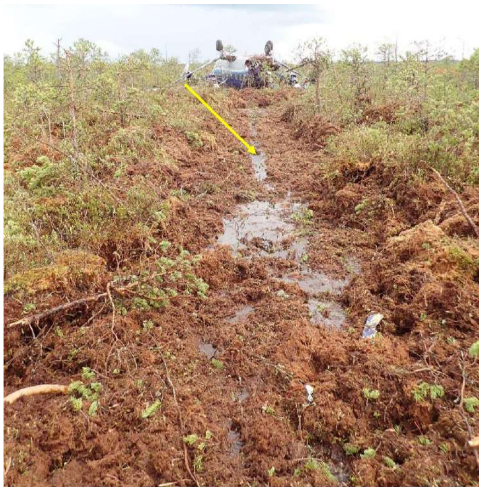
Рис. 17. След нижней части фюзеляжа и передней стойки ВС (указан стрелкой)
