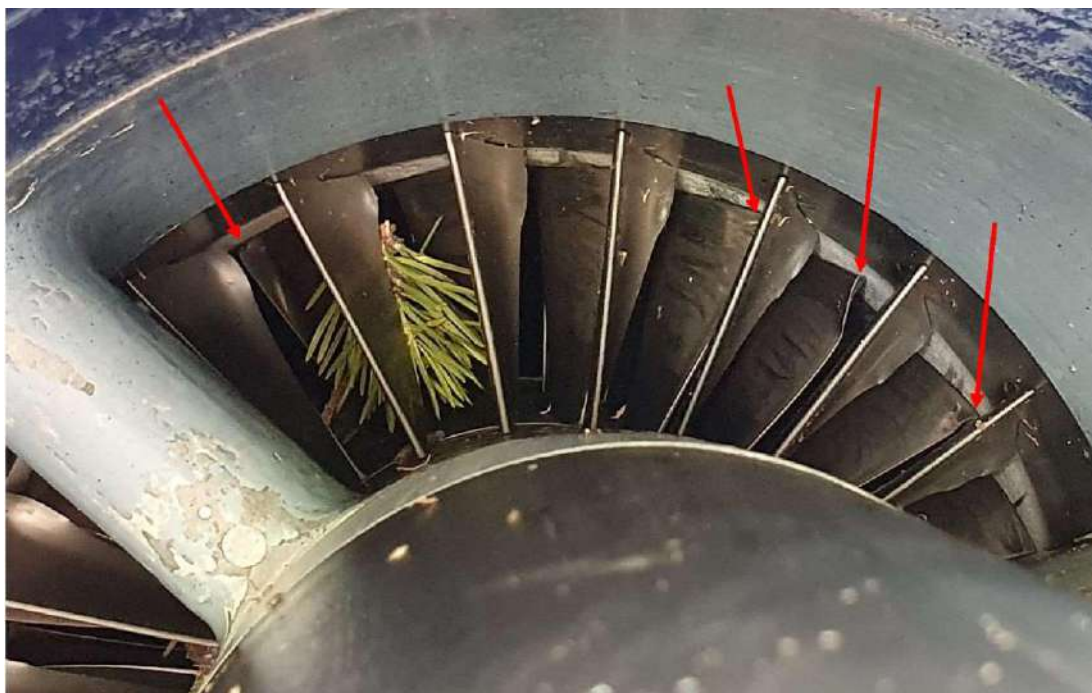
Рис. 8. Повреждения лопаток первой ступени компрессора левого двигателя (указаны стрелками)
