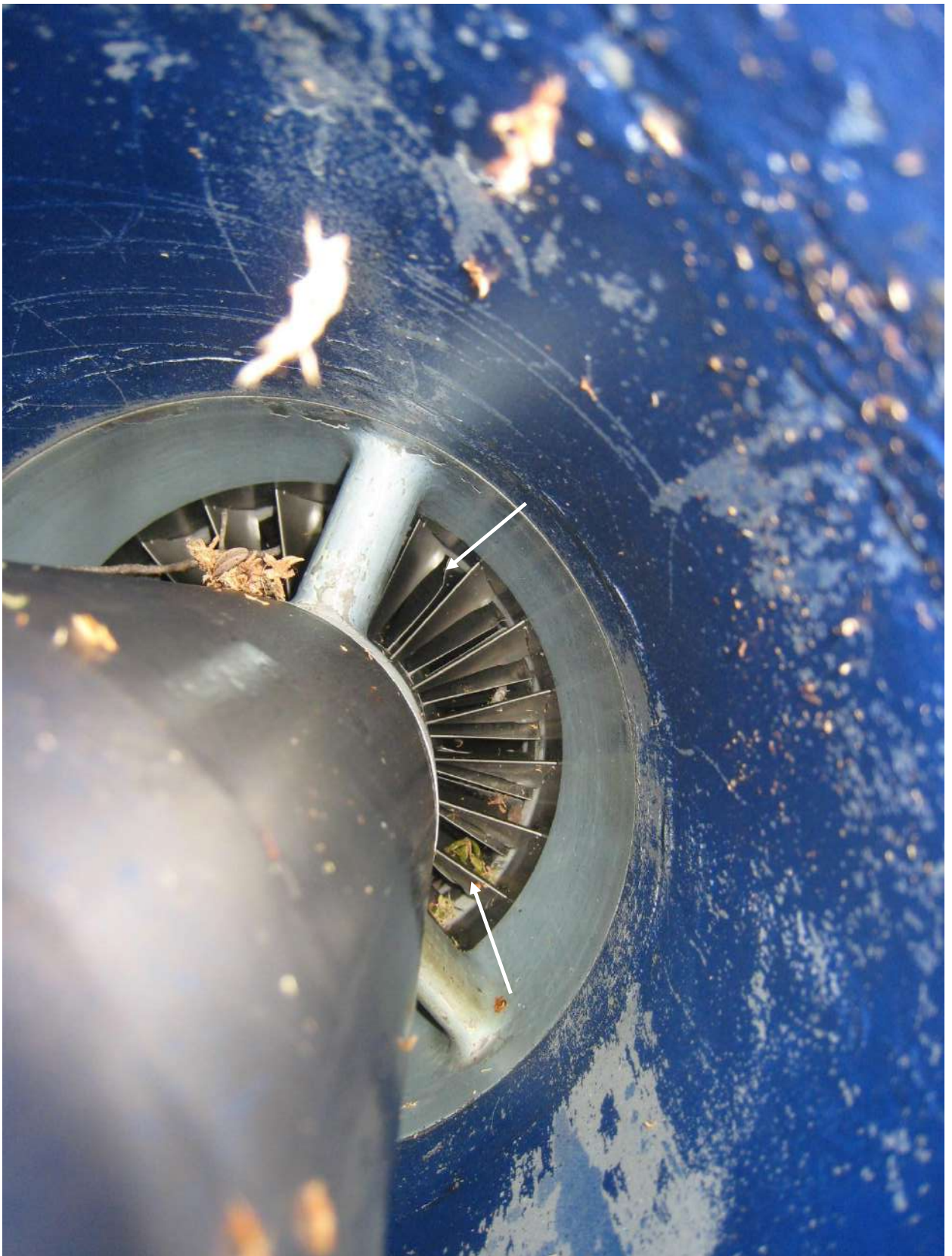
Рис. 7. Повреждения лопаток ВНА левого двигателя (указаны стрелками)
