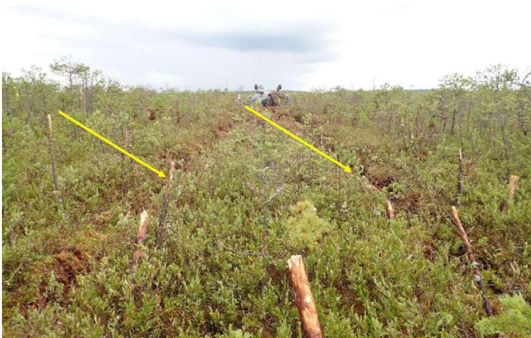
Рис. 16. Начало следов от основных колес стоек шасси ВС (указаны стрелками)
