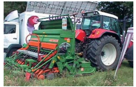
Mulchsaatkombination mit der die Samen ohne Ackerfurchen in die Pflanzenreste aus dem Vorjahr einsät werden.
