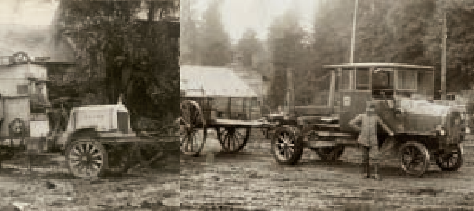
Bauernwagen als Anhänger für Lastkraftwagen zum Transport von Masten, Juli 1917. Vorlage: Landesarchiv GLAK 456 F 119/14
