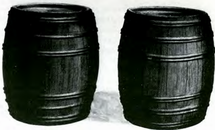
1. Salttunnor från Lüneburg, bruttovolym 223 l. Rekonstruktion efter ett mäs- tarprov från början av 1600-talet.
