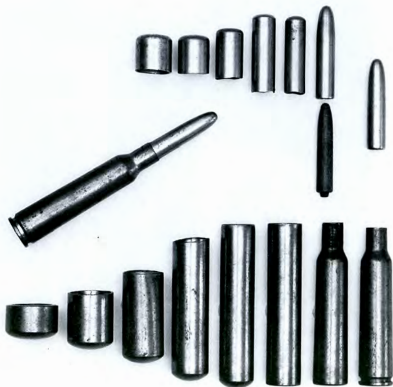
4. Bearbetningsstadier vid dragning av hylsa och mantel för 6,5 mm gevärsammunition. Tekniken är i princip den samma vid tillverkningen av moderna ölburkar. Kulturen.
