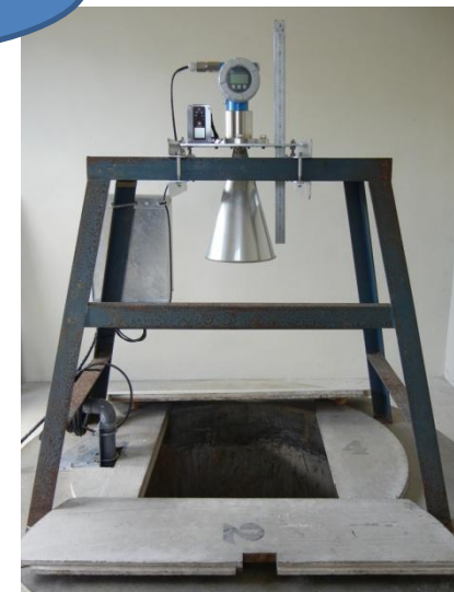
観測機器の更新(電波式検潮儀)
