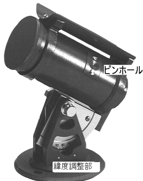
写真 8-1 ジョルダン式日照計
