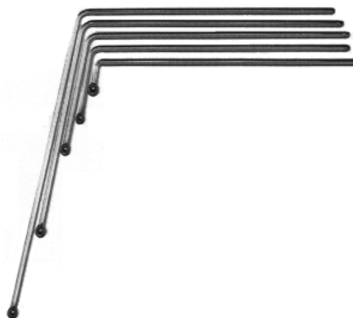
写真 3-2 曲管地中温度計
