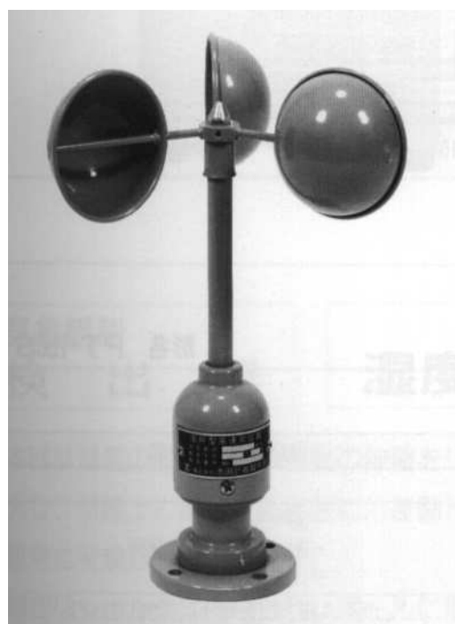
写真 4 - 2 風杯型風速計
