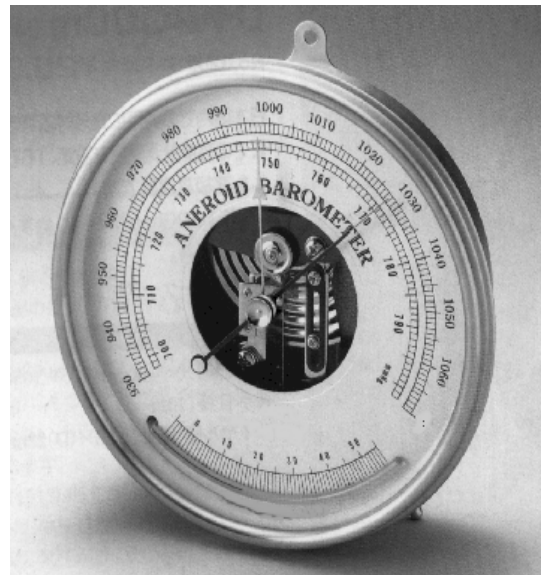
写真 6-2 アネロイド型気圧計
