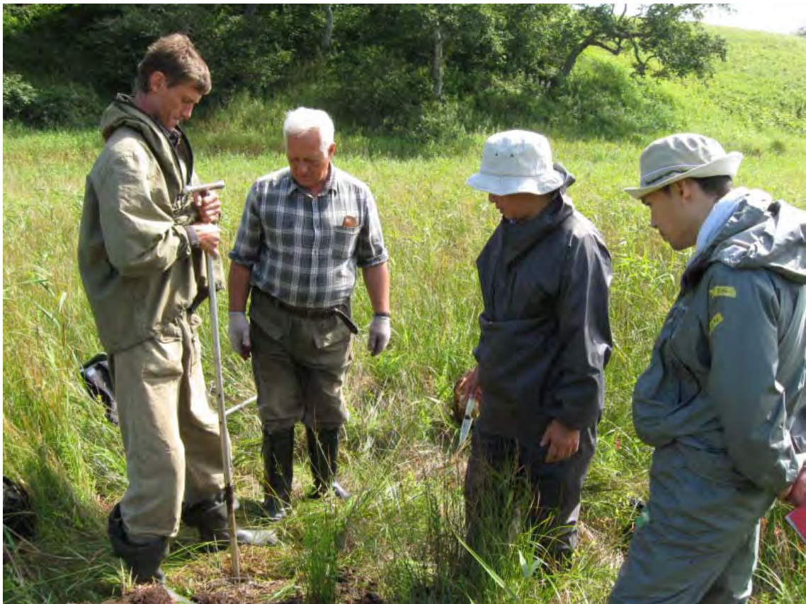
写真4 ピートサンプラーでの表層地質調査（色丹島イネモシリ）
