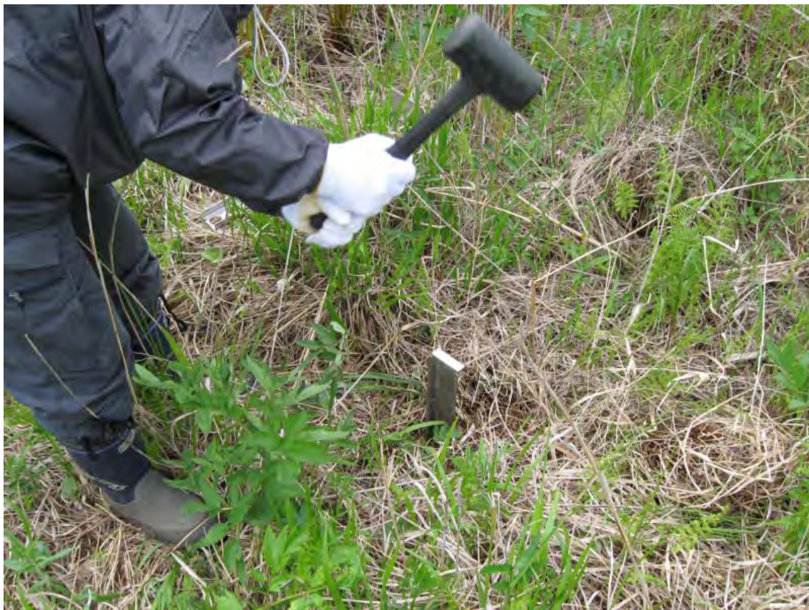
写真1 十勝平野太平洋岸でのハンディジオスライサーによる掘削調査の様子
