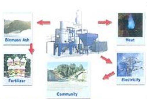
Gambar 8.4.3. Konsep sistem gasifikasi biomassa.
