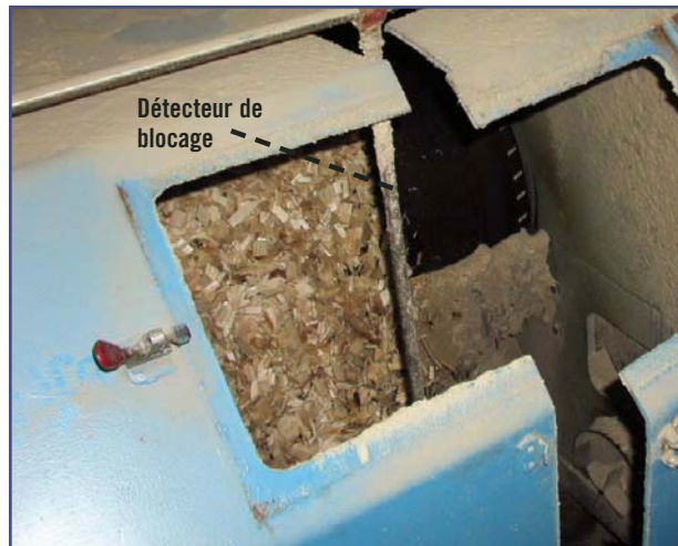
FIGURE 3-19 OUVERTURE DE LA CHUTE POUR DÉBLOCAGE ET DÉTECTEUR DE BLOCAGE
