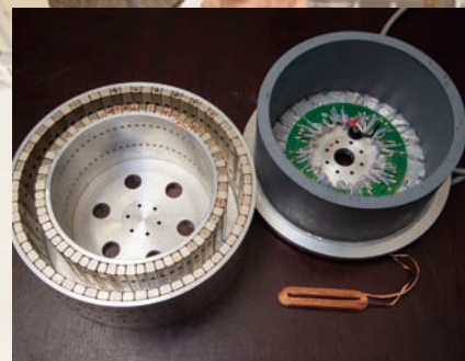
写真左:ローター (回転子)。ハルバツハ配列の磁石を外輪と内輪に向かい合わせて2列(デュアル)に並べて磁力を高める。右:コイルを収容するステーター(固定子)。
