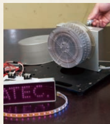
コギングがないため、軽い力でもするすると抵抗なく回せて発電できる。
