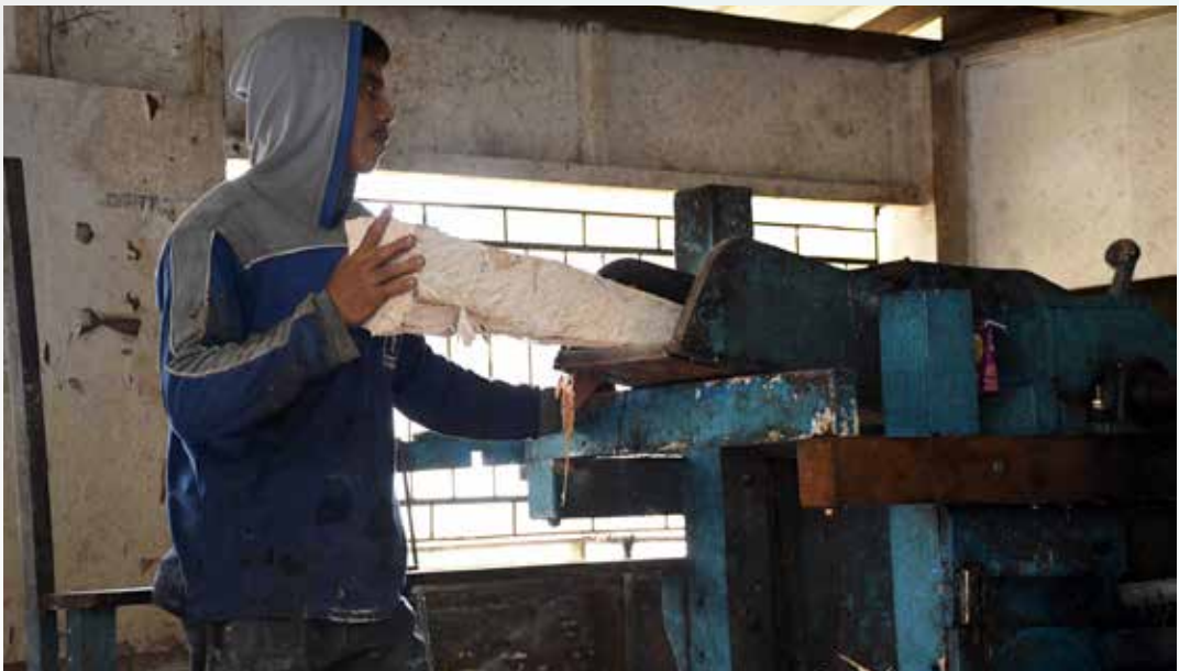
PROSES penggarutan menggunakan mesin yang dibuat sendiri oleh pemilik syarikat kilang sagu.
