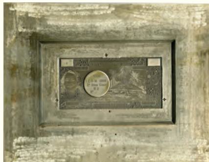
Matrice de fabrication du cliché d'impression typographique de l'une des quatre couleurs du recto du billet de 1 000 francs CFP 1969 (bleu clair).
