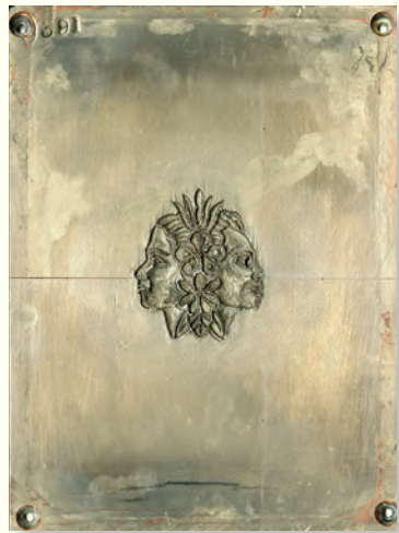
Matrice métallique pour la fabrication du filigrane du billet de 10 000 francs CFP de 1986.
