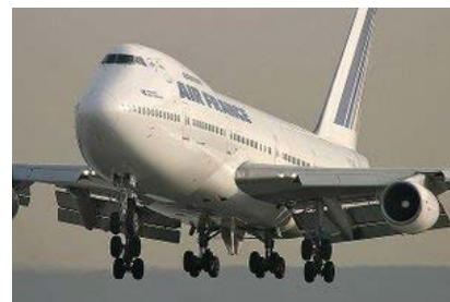
図9 B747は4脚で主脚を構成
