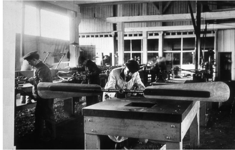
Ateliers Voisin de Billancourt, 1908, fabrication des hélices d'avions. (Archives municipales de Boulogne-Billancourt).
