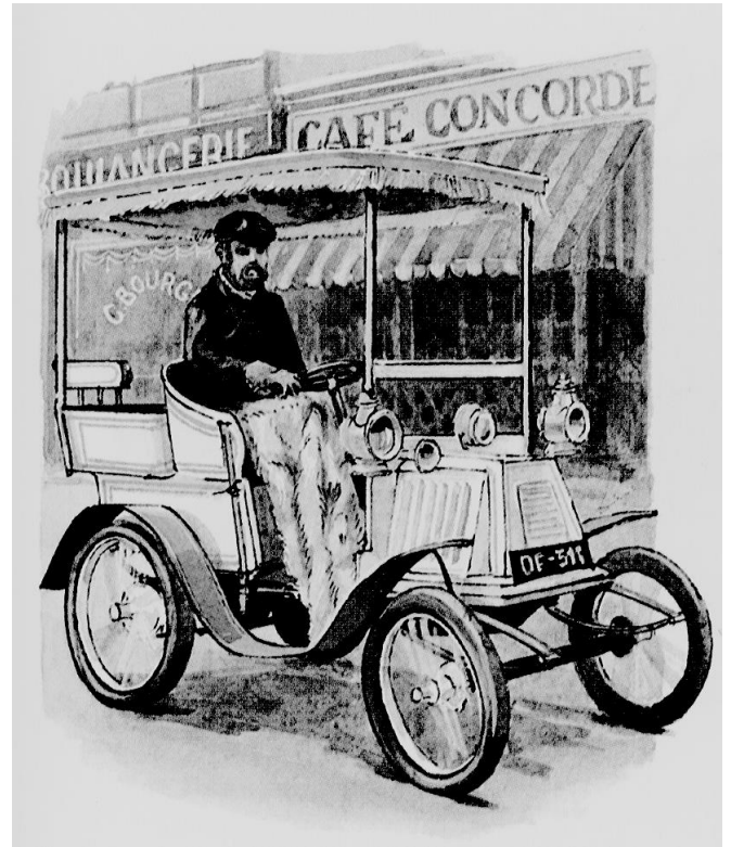
Voiture Renault en 1901 : puissance un cheval 3/4 pour une cylindrée de 273 cm 3 , avec radiateur d'eau placé derrière le moteur, signe distinctif de la marque.
