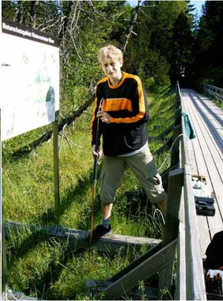
Tafel 19.: Einsatz der Porenwasserpumpe
