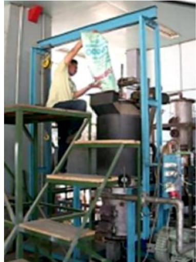
atau batubara dengan bentuk partikel seragam dan bagus, seperti: serpih kayu, blok kayu atau pelet. *Fixed bed gasifier* biasanya berupa tungku vertikal dan tahapan proses dapat diidentifikasi. Gasifier *fixed bed* dapat dikelompokkan lagi menjadi tiga tipe berdasarkan aliran bahan baku yang diumpankan antara lain: *updraft*, *down draft*, dan *cross draft gasifier*.
