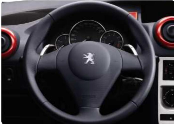
En mode séquentiel, vous changez de vitesse par de légères impulsions sur les palettes situées au volant. Simple, rapide, sans que vos mains quittent le volant ! Vous pouvez aussi changer de rapports en utilisant le levier de vitesses. Une impulsion vers l'avant pour monter d'un rapport, une impulsion vers l'arrière pour descendre. Un modèle d'efficacité et d'ergonomie, pour encore plus de sensations.
