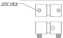
SADDLE HEIGHT ADJUSTMENT SCREW P/N 0081459000 TRUSS ROD NUT P/N 0038454000
