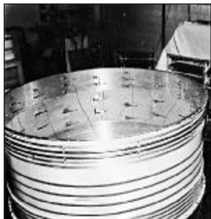
Система термостабілізації корпусу супутника за допомогою теплових труб.
