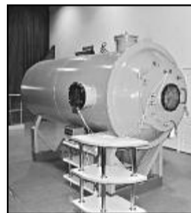
Вакуумний стенд із малою камерою для вогневих випробувань плазмових прискорювачів холлівського типу (зліва) та вакуумний стенд із великою камерою для вогневих випробувань моделей установок плазмових прискорювачів холлівського типу, які обладнали вчені лабораторії кафедри двигунобудування.
