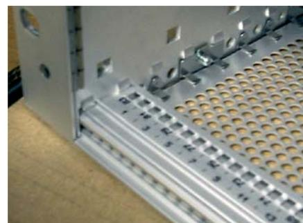
Рис. 8. Крепление поперечного рельса к боковой панели
