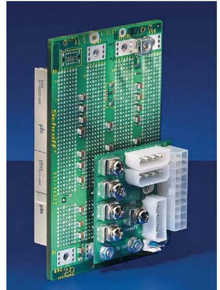
Рис. 16. Кросс-плата CompactPCI с мезонинной платой питания
