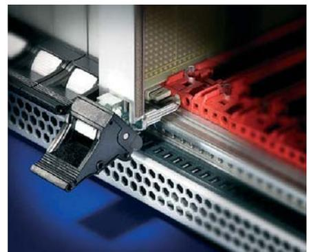
Рис. 5. Установка модуля CompactPCI с помощью специальной ручки
