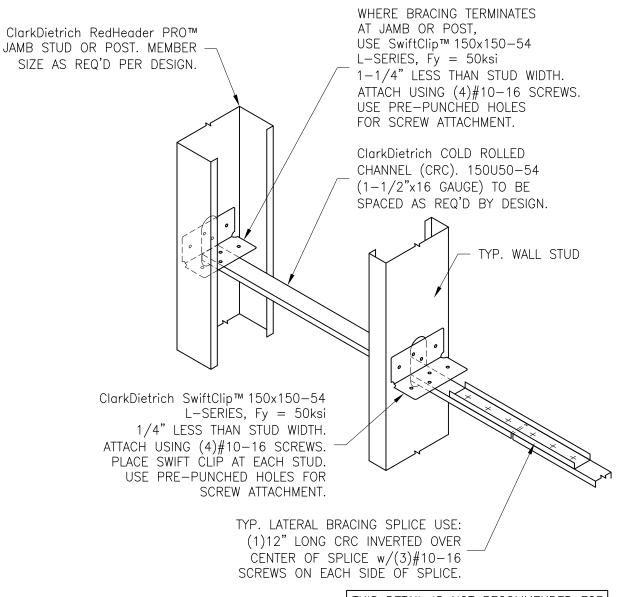
THIS DETAIL IS NOT RECOMMENDED FOR WALL STUDS DEEPER THAN 8"
