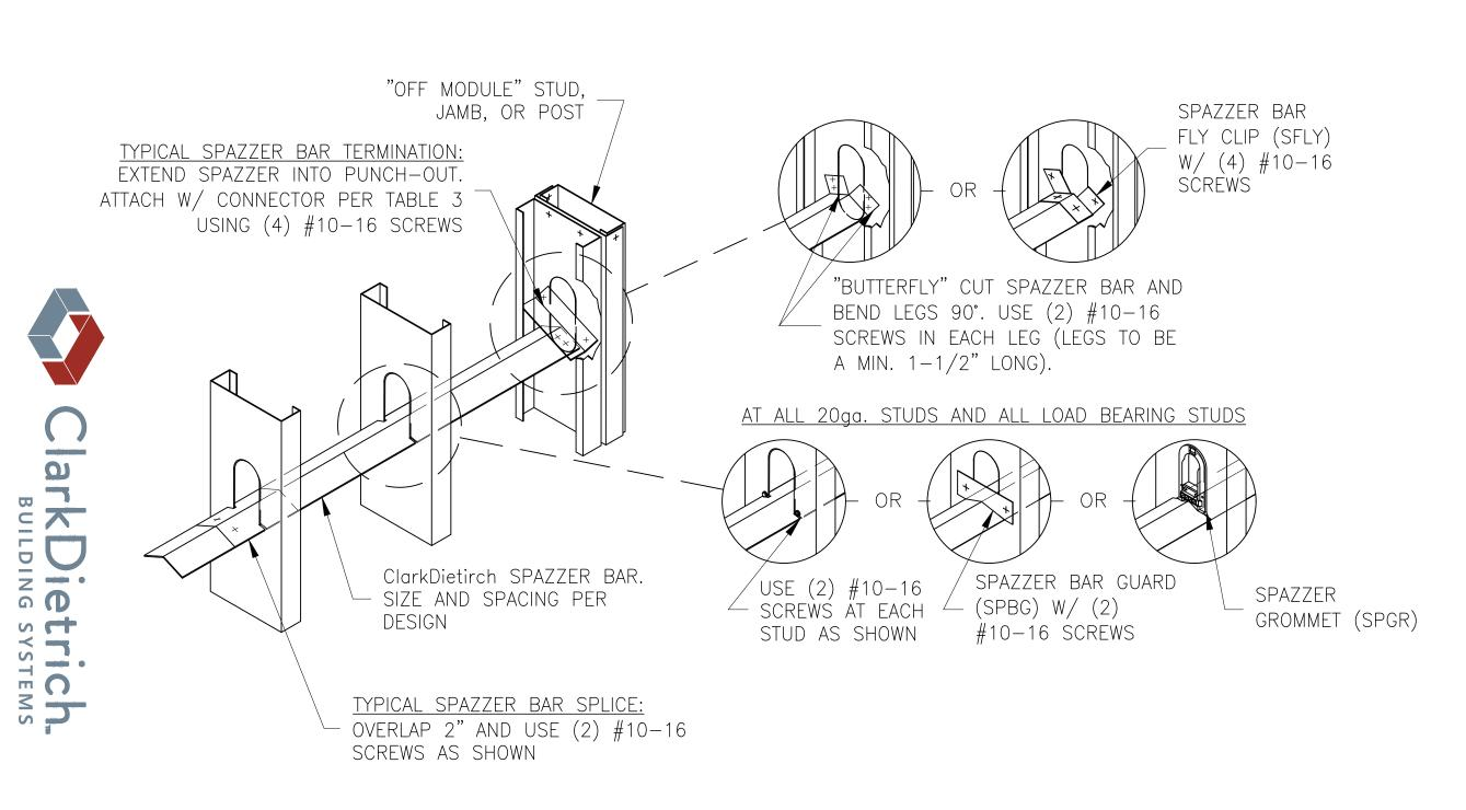
SPAZZER BAR IS NOT SUITABLE FOR WALL STUDS DEEPER THAN 8"
