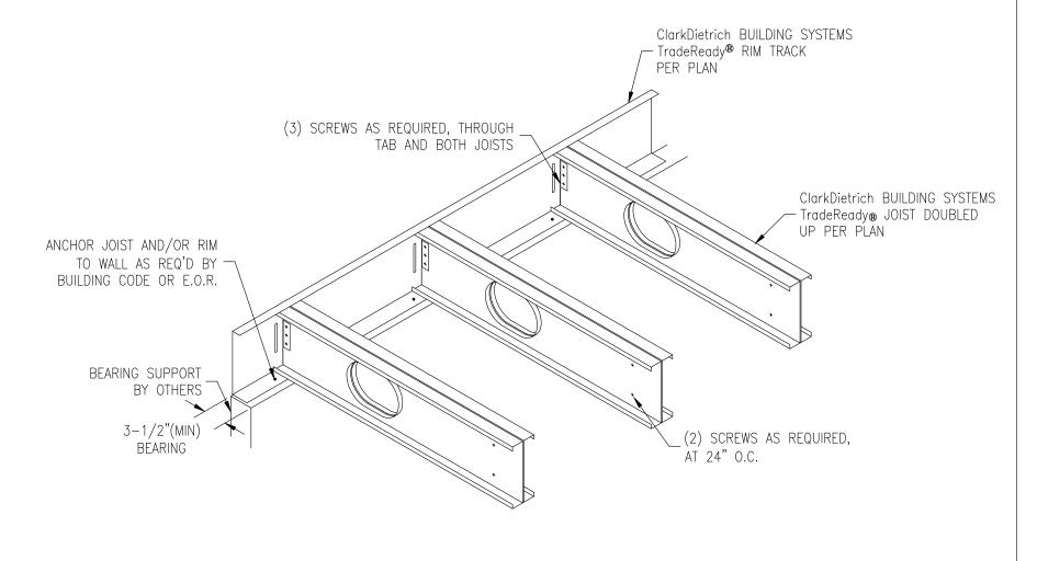
JOIST RIM — DOUBLE JOISTS
