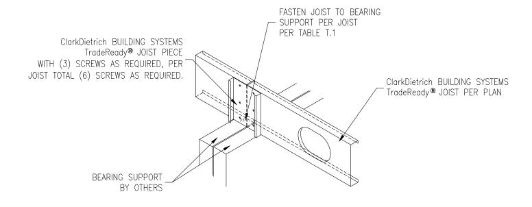
JOIST LAP - END-TO-END W/SPLICE BLOCK
