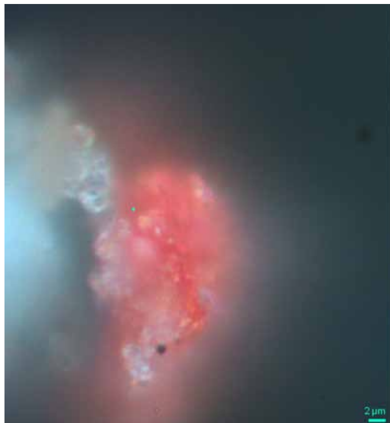
32 - Imagem microscópica do vermelhão utilizado nas áreas vermelhas. Grãos brancos de calcite utilizados como carga na tinta. Escala 2 µm.
