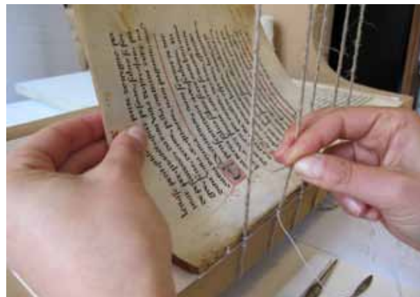
28 - São bem visíveis os nervos de corda, fixos ao tear de encadernação
