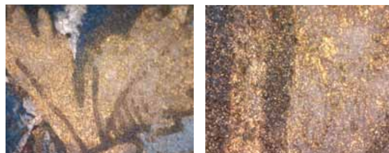
46a/b - Microfotografia do douramento da coroa aberta no escudo de armas: ampliação x50 e ampliação x210
