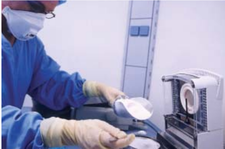
Contrôle d'humidité du grain
