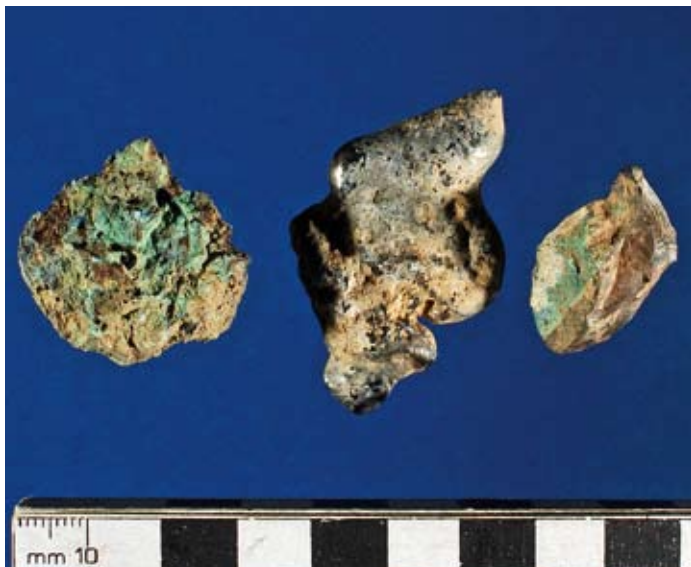
Abb. 14: Beispiele für alte Verhüttungsschlacken aus dem Kosovo mit grünen (Cu-Verbindungen) und weißlichen (Pb-Verbindungen) Ausblühungen an der Oberfläche
