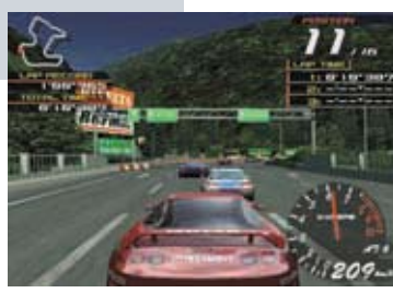
「リッジレーサーV」の画面。クルマのボディ表面の映りこみは環境マッピングで擬似的に表現している。
