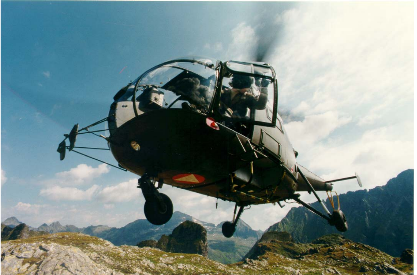
Approche sur une zone restreinte et difficile. Le mécanicien de bord ouvre la porte et guide le pilote pour l'atterrissage complet bien que celui-ci puisse aussi s'aider des rétroviseurs ( photo © Pierre GILLARD ).
