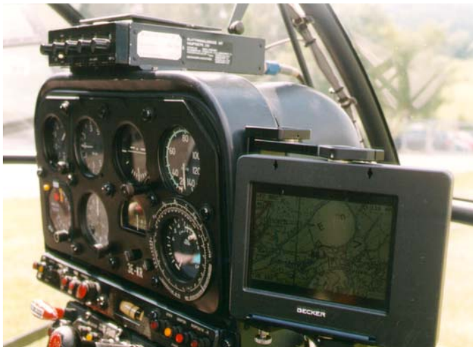
L'écran à carte mouvante du GPS Becker installé sur le flanc de la console d'instruments. « Je me suis perdu, chef » n'est plus une excuse avec ce genre de système ! ( photo © Pierre GILLARD ).
