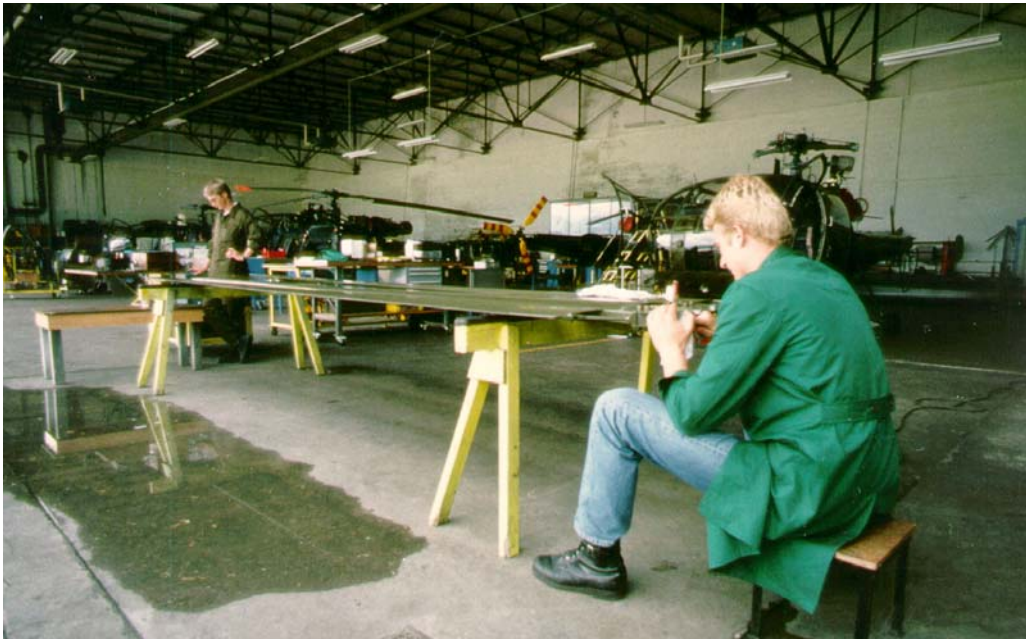
Technicien effectuant consciencieusement l'entretien d'un pied de pale d'Alouette ( photo © Pierre GILLARD ).
