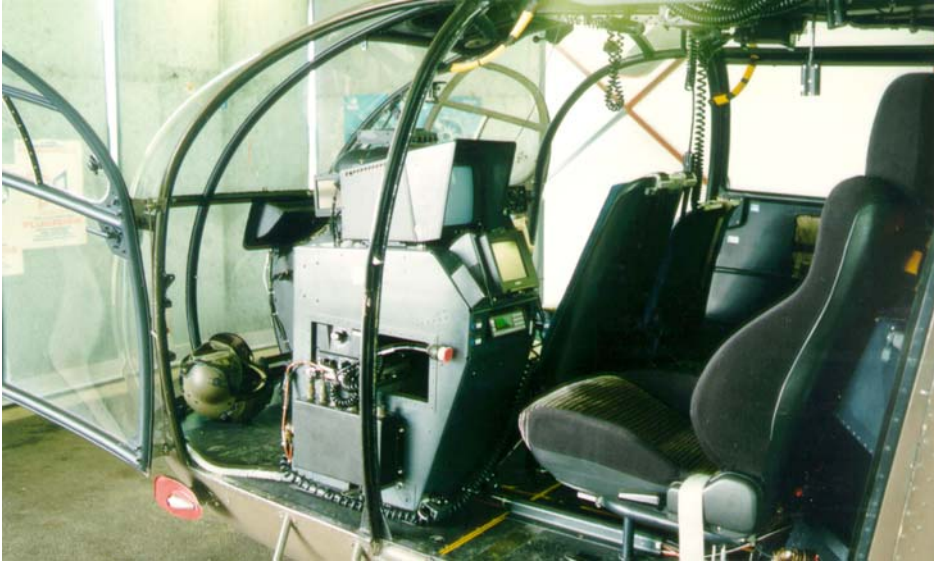
Vue de la console spéciale de contrôle du FLIR. A noter, aussi, le siège type Honda CRX, le seul du genre de toute l'histoire de l'aviation !
