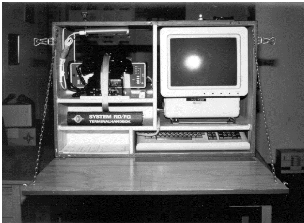
Alfascop 35 med telefon och telefonmodem för uppringning till DELTA. Denna bärbara utrustning för utlåning vägde cirka 40 kilo.
