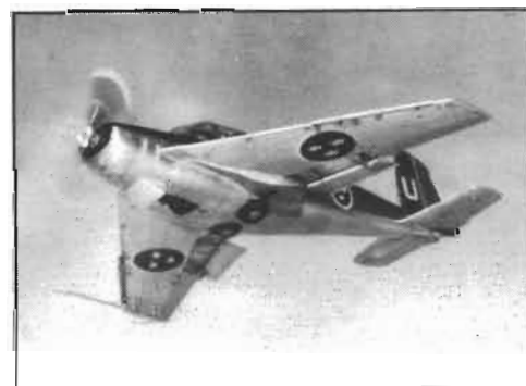
Precis som man gjort med 29-vingen provades på en SAFIR även LANSEN-vingen. Här ovan SAAB 202 med de stora "Fowler"-klaffarna i utfällt läge.
