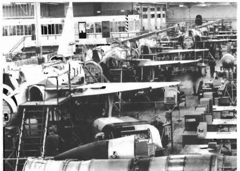
Monteringshallen för flygplan 37 på SAAB-fabriken i Linköping.
