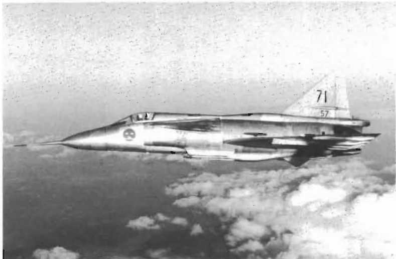
Första provflygplanet – en AJ37 – med monterad "Oerlikon" 30 mm automatkanon avsedd för Jakt-VIGGEN (JA37).
